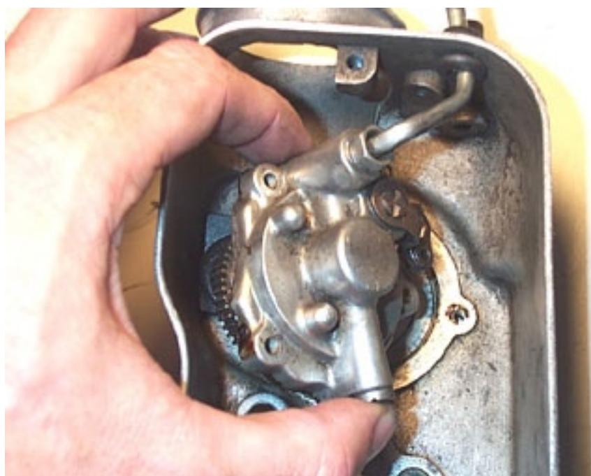
Non c'è davvero molto da riparare nella pompa se non sostituire la guarnizione e assicurarsi che i percorsi siano liberi. Per eseguire la manutenzione della pompa dell'olio nel sistema precedente, rimuovere le tre viti a testa piatta che fissano il corpo della pompa alla scatola del carburatore. Una volta rimossi, puoi farlo ruotare con attenzione la pompa fuori dalla scatola .....
