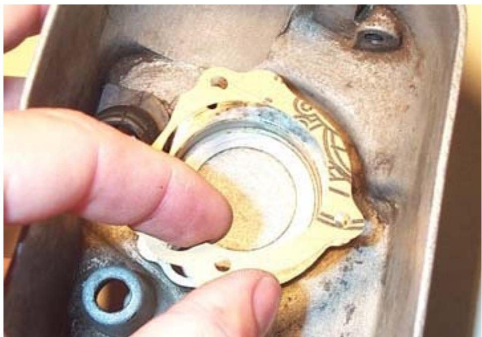
Quando si sostituisce la pompa nel corpo del carburatore, utilizzare sempre una nuova guarnizione tra di loro.
