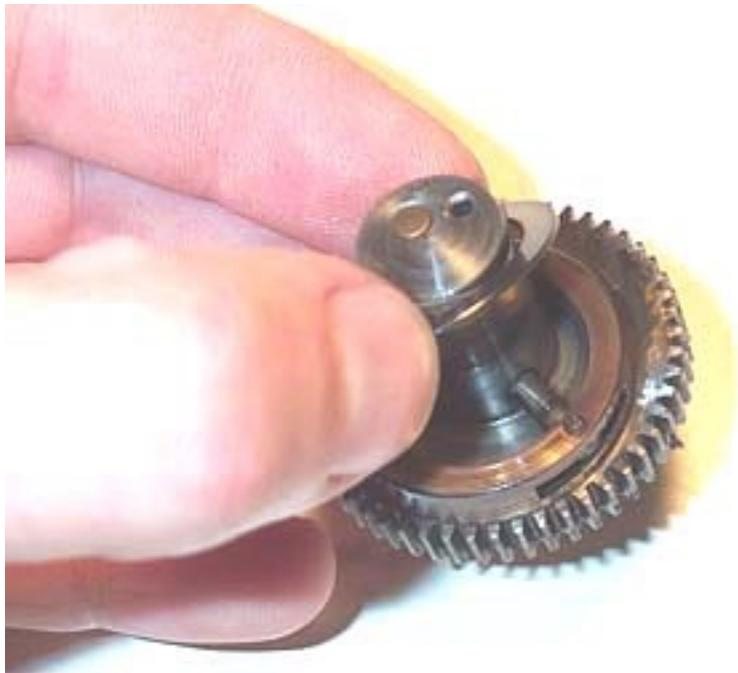
... e infine una piccola boccola tra i due. L'ho smontato per vedere come funzionava più di ogni altra cosa (sono così). Per la manutenzione assicurati che tutte le parti siano pulite e che i passaggi nella scatola del carburatore lo siano anche pulito.
