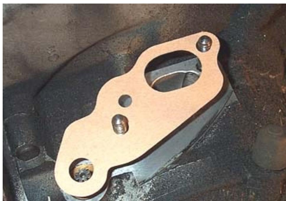
Quando installi la scatola del carburatore, usa una nuova guarnizione tra l'involucro e la scatola. Ci sono un sacco di guarnizioni diverse là fuori, quindi assicurati di averne una con un foro per l'ingranaggio di trasmissione del mixer.
