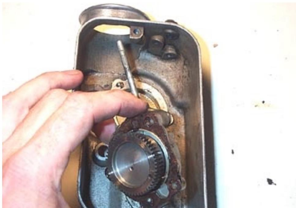
... e fai scorrere la linea di aspirazione dell'olio attraverso il corpo della scatola del carburatore. Gettare la vecchia guarnizione in quanto dovrebbe essere sostituita ogni volta che la pompa viene rimossa.
