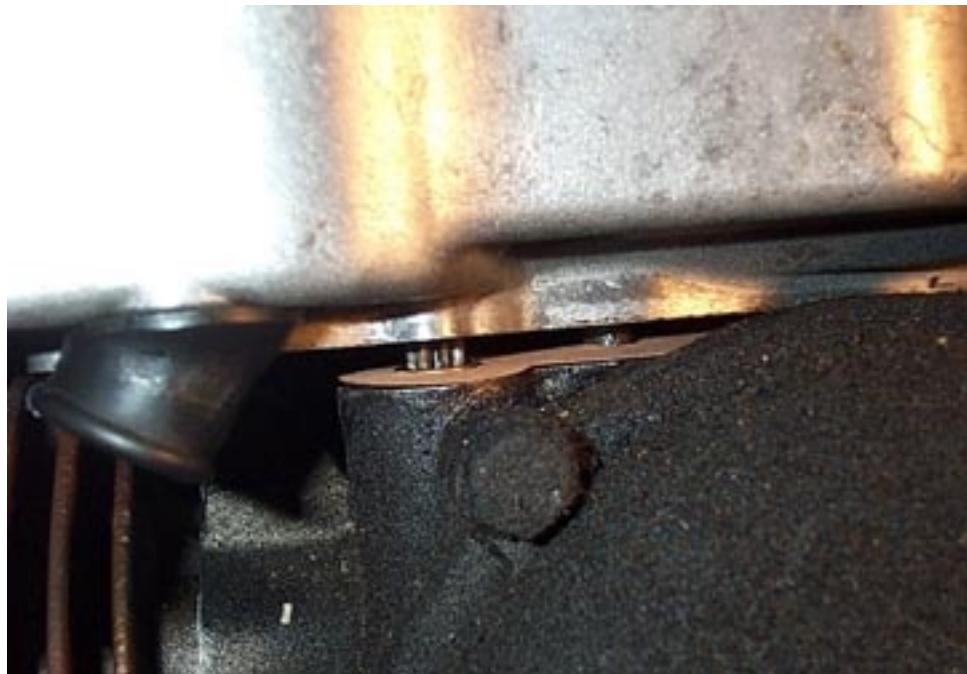
Assicurarsi che l'ingranaggio si innesti nel foro della pompa dell'olio quando si posiziona la scatola sull'involucro.
